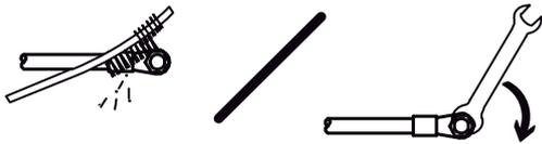
Verificar e limpar conexões dos cabos de solda
